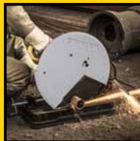
9 Corte de barras de refuerzo, vigas de acero y ángulos de hierro. Tronzadora STEL701
